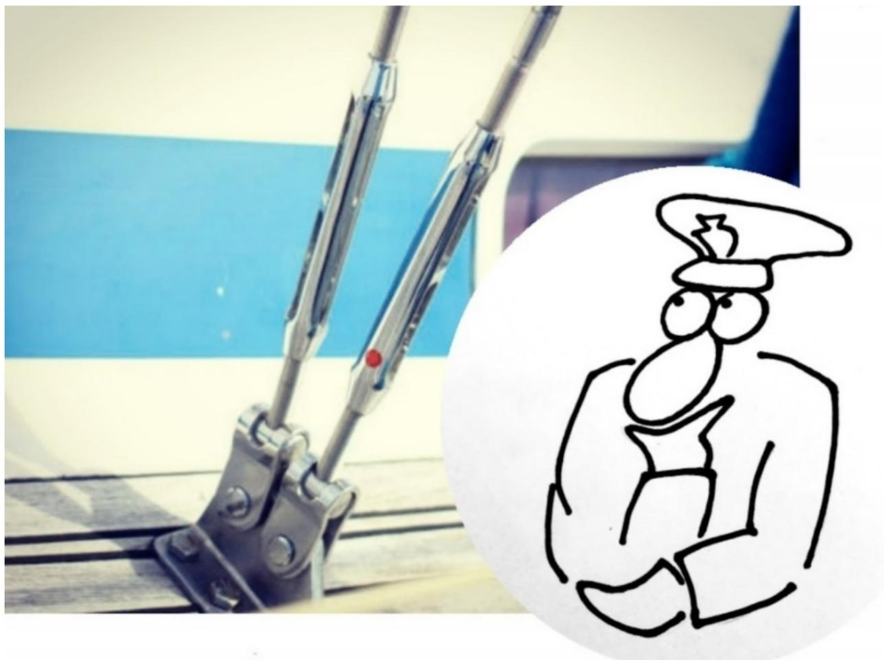
L' ARRIDATOIO, detto anche TENDITORE, è un meccanismo usato per portare e mantenere alla giusta tensione i cavi che tengono fissati gli alberi delle navi e delle imbarcazioni.
